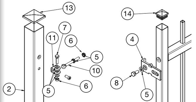
Die Torbandlasche (4) mithilfe der Unterlegscheibe (5) und der Sechskantschraube (8) am Torrahmen befestigen. Die Augenschraube (10) mitsamt den Unterlegscheiben (5), den Sechskantmutter (6) und der Sechskantschraube (7) an den Scharnierpfosten anbringen.
